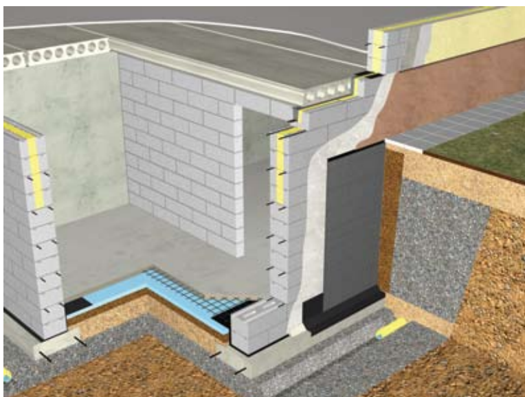
Kuva 4.8 C) Kellarillinen perustus: paikalla- valettu betoniantura.
